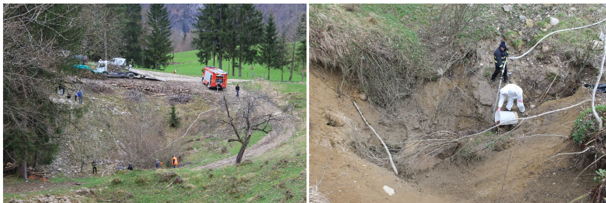
Slika 1: Injiciranje fluorescenčnega sledila naftionata 17. aprila 2018 med 11:15 in 11:35 na dnu usada v zaselku Perniki nad dolino Radovne.
