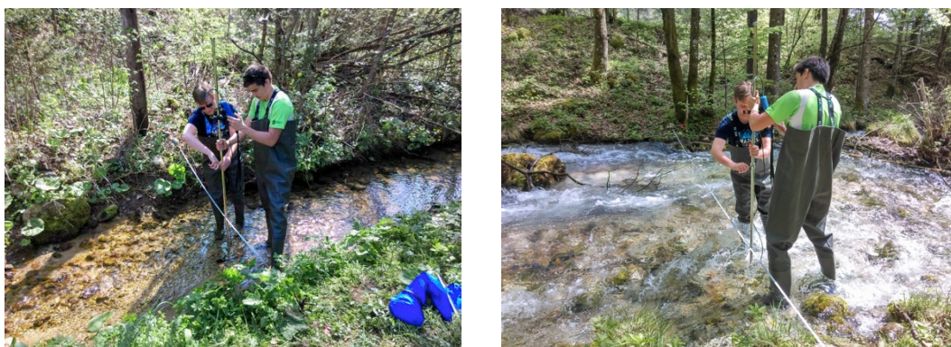
Slika 5.: Meritve pretoka s hidrometričnim krilom (levo na Tročini, desno na Zatrepu)
